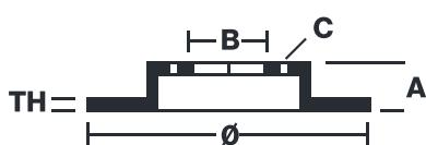
**Diameter** **259 mm** **Thickness (TH)** **9 mm** **Height (A)** **30,4 mm**
