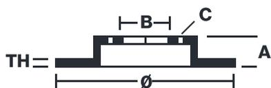
EAN code **8020584574522** Diameter  $\varnothing$  **288** mm
